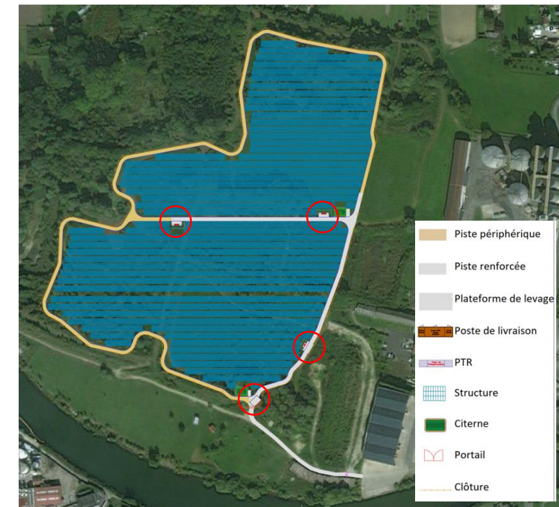
Localisation des postes électriques
